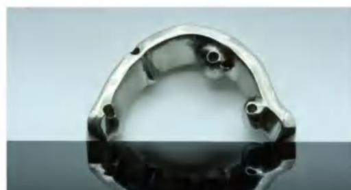
金属 3D 打印钛合金杆卡
