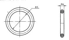
图 1 典型的 O 形圈结构
