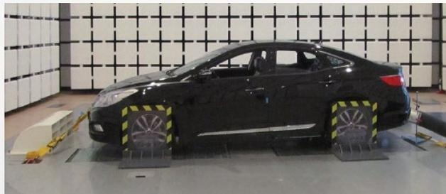
**应用：**适用于在电波暗室内开展整车EMC测试需求。
