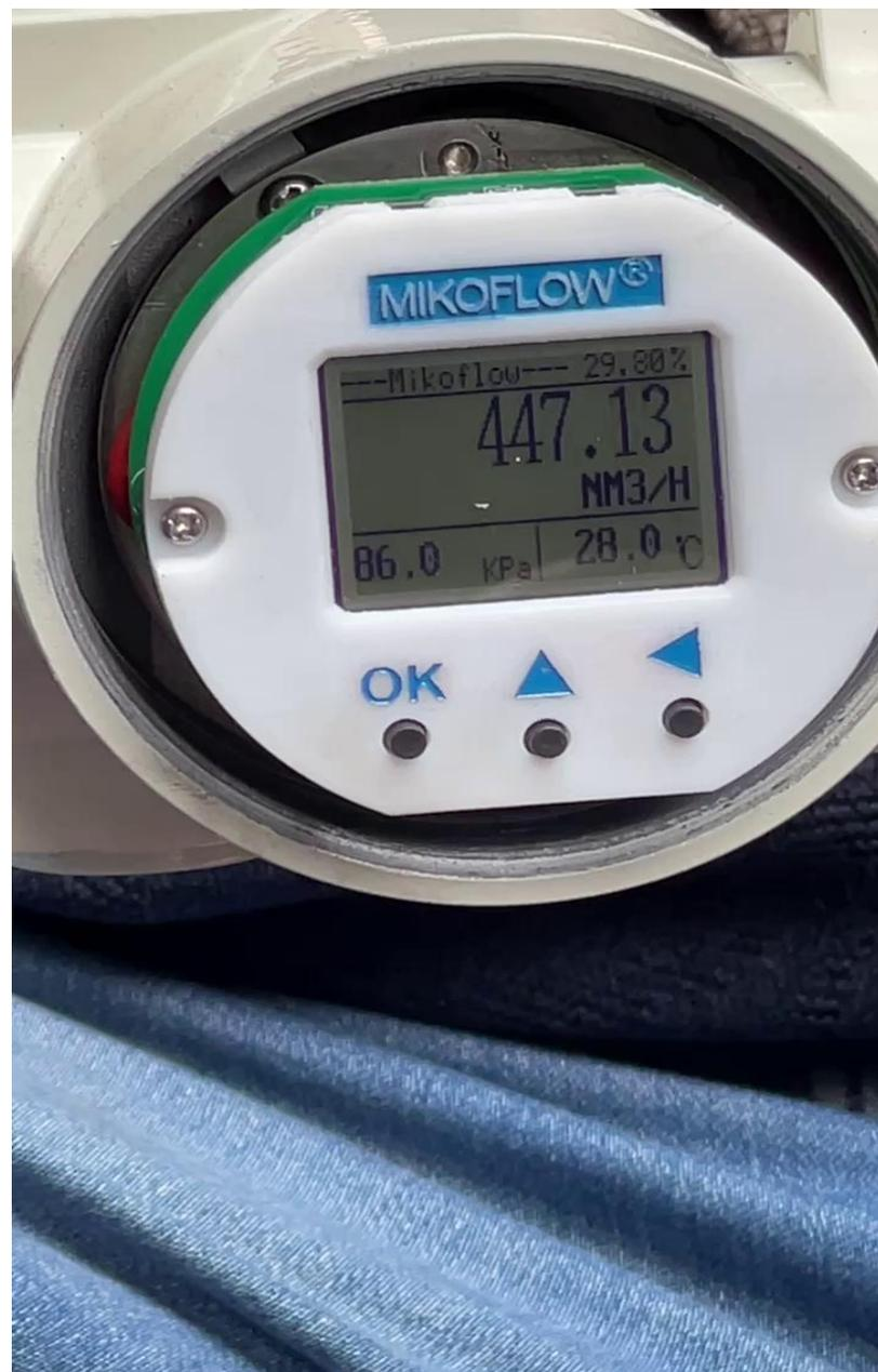
**应用四：**1420mm管径 焦炉煤气
