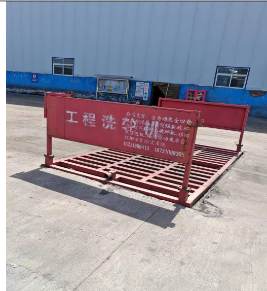
洗车台沉淀池
