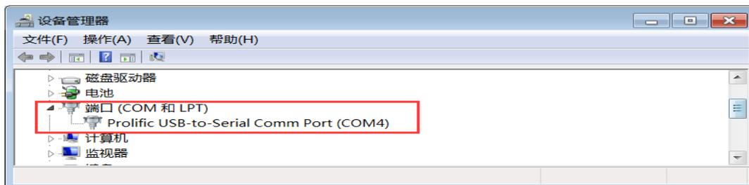
3. 打开串口调试助手, 选择模块端口号及对应的串口参数, 打开端口。
