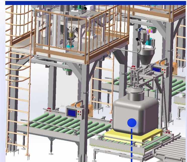
人工打开袋口，吸料管自动伸入吨袋，吸取多余物料，减料后再次确认称重数据，直至重量满足范围
