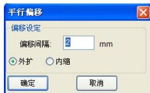
选中需要的选项及参数，点击确定后，会自动生成和原来图形平行的加工图形，如下图所示。
