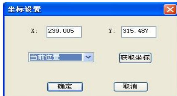
可以在 X/Y 处直接输入坐标值做为加工起始点，
