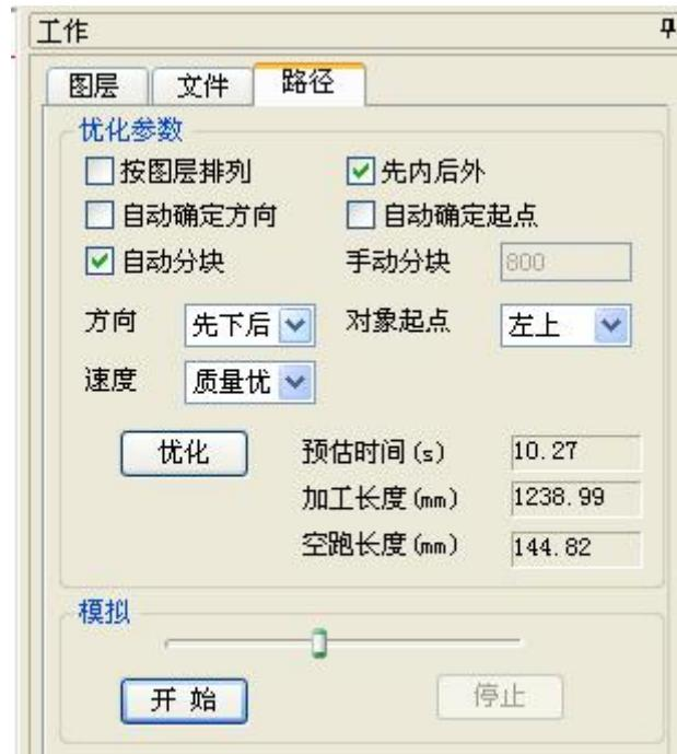
在这里最重要的是分块处理的分块高度设置 **分块高度**  在这里需要注意的是在设置时设成和加工图形的宽度大小差不多，同时还需是封闭图形，请按需要勾选优化参数然后点优化按钮 **优化**，软件会自动计算出预计估算加工时间加工切割长度和不需要加工的空跑长度，在点击加工预览模拟 **开始** 如图所示
