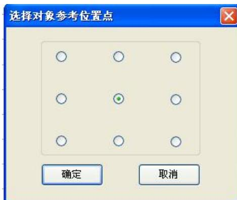
选取一个或多个对象时，被选取对象四周会产生一个由八个方点和一个 X 组成的可编辑框，把鼠标放到 X 上按下鼠标左键拖动鼠标，可以拖动选取的对象，把鼠标放到到八个方点中的任一方点上，按下鼠标左键拖动鼠标，可以放大/缩小选取的对象。被选取对象的八个方点和一个 X 对应上图的九个圆圈，在上图中选择不同位置的圆圈，其后的 坐标值会相应改变。
