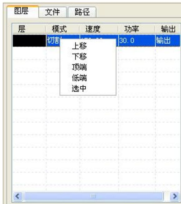
单击 **上移** 该图层上移一层；单击 **下移** 该图层下移一层；单击 **顶端** 该图层上移到最顶端；
