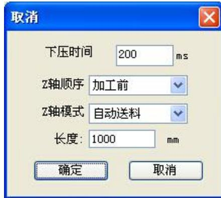
**Z 轴顺序：**有两种顺序可供选择，加工前送料或加工后送料，即先加工再送料还是先送料再加工。
