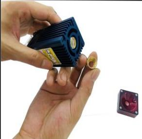
3. Снимите и замените оконную линзу.
