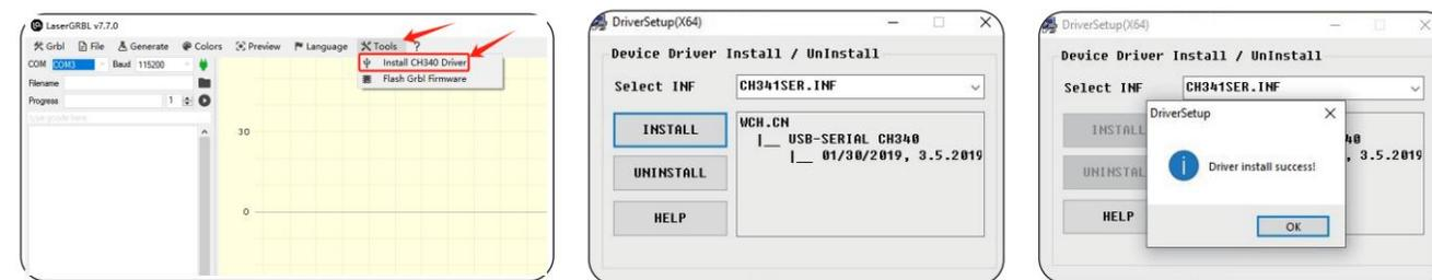
ドライバーのインストールに失敗した場合は、図に示すように、ドライバーを再度開き、[アンインストール] をクリックし、次にドライバーを再度開いて [インストール] をクリックします。
