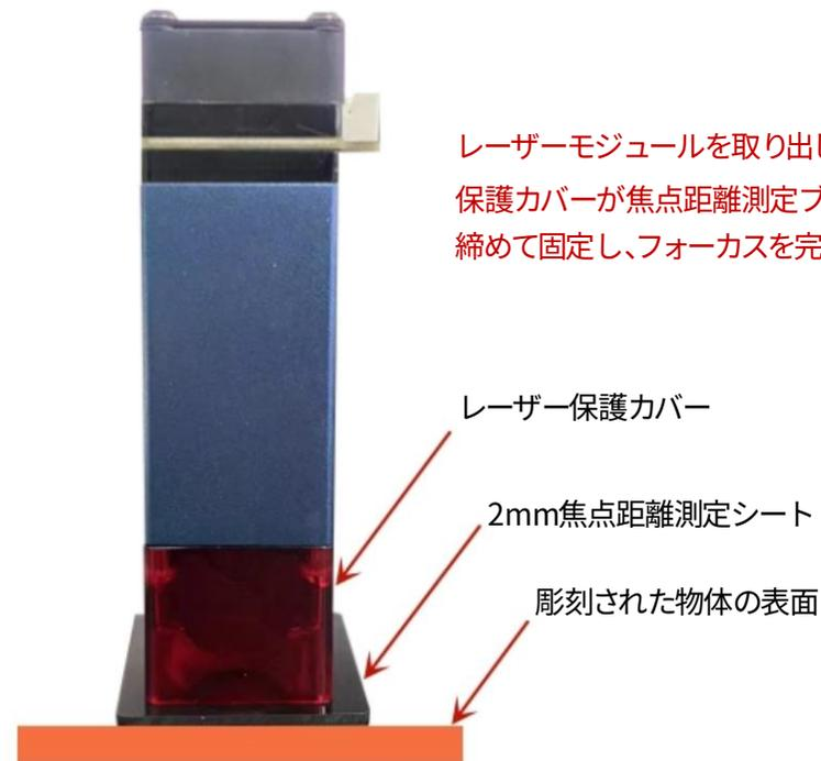
レーザーモジュールを取り出し、スライドスロットに挿入します。赤い保護カバーが焦点距離測定ブロックの表面に触れたら、サイドノブを締めて固定し、フォーカスを完了します。
