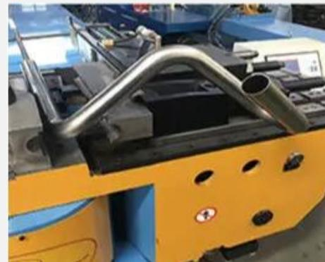
弯管机：三维弯管机是实现管道弯曲的核心设备，通常由控制系统、液压系统、弯曲机构、定位机构和弯管模等组成。控制系统负责设置弯曲参数，液压系统提供动力，弯曲机构实现管道的弯曲，定位机构保证管道在弯曲过程中的位置稳定，弯管模则根据管道直径和弯曲角度设计。
