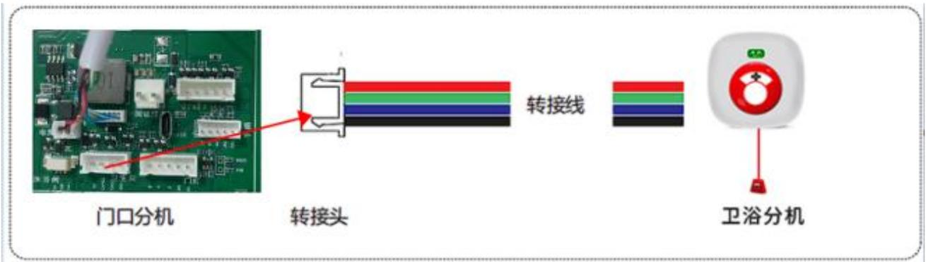
转接头为 4PIN 接头，转接线一般采用网线，连接线颜色一一对应即可。
