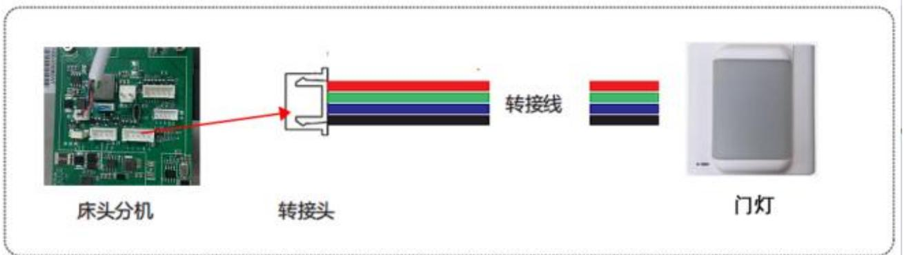
转接头为 5PIN 接头，转接线一般采用网线，连接线颜色一一对应即可
