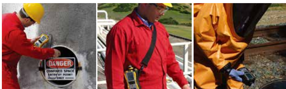
采用 MultiRAE Lite 进行受限空间测试 MultiRAE 用于炼油厂工人的暴露监测 利用 MultiRAE Pro 进行 CBRN 检测
