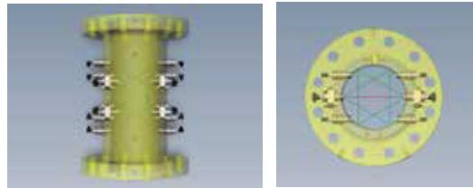
Q.Sonicmax采用三对平面内直接交叉的X形声道和两个涡流双反射声道实现精密的声波成像和气流侦测
