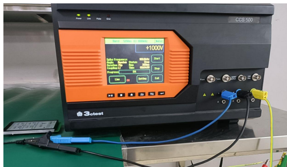
3.2 群脉冲测试图 EFT test
