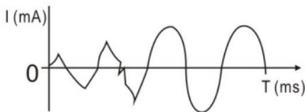
图1、直接接触电流波形示意图
