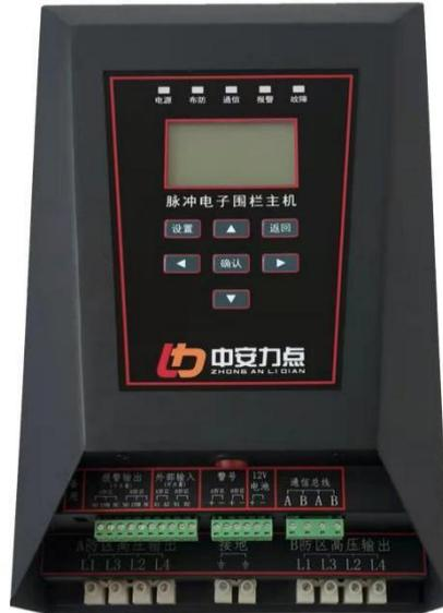
图 2 脉冲探测器
