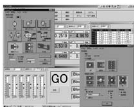
系统图表 打印机滚筒同步多点式测量例子
