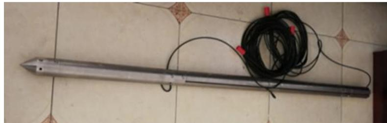
孔隙水压力探杆
