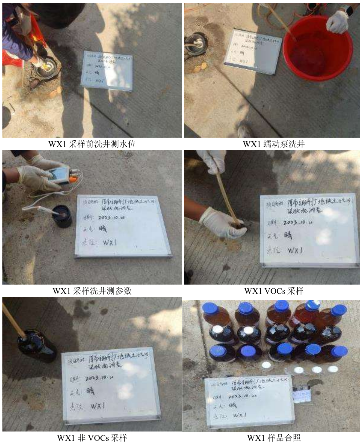
图 5.2-3 地下水样品采集过程照片
