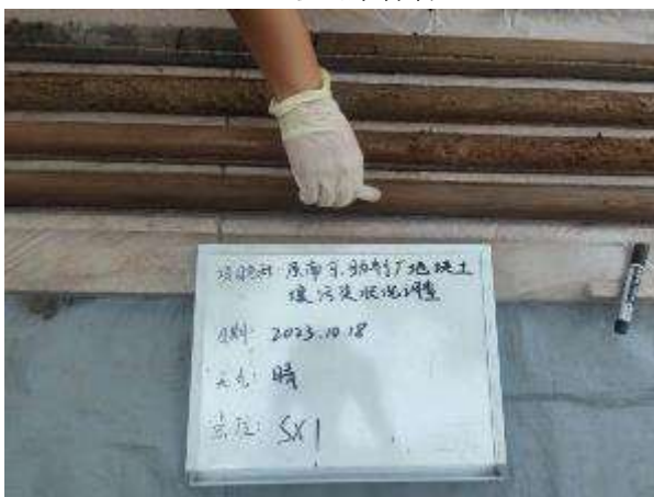
SX1 土壤 VOCs 取样
