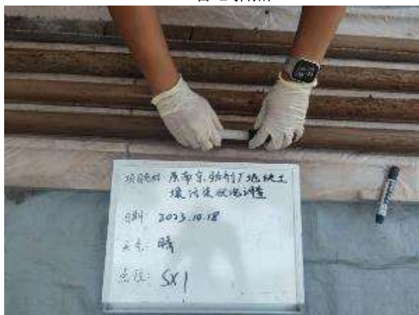
SX1 土壤 VOCs 装样
