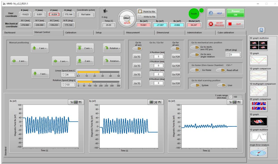
**Manual positioning 手动位移控制：**用户通过键盘可以控制探头和转台的移动，四个箭头控制 XY 方向，Page up/down 控制 Z 轴升降，+/-控制转台正反转。按住以上所述的这些键盘方向控制同时按住 Shift 键可以缓慢移动探头，为了保护探头安全，建议探头在距离被测物体较近时配合 Shift 键缓慢移动。
