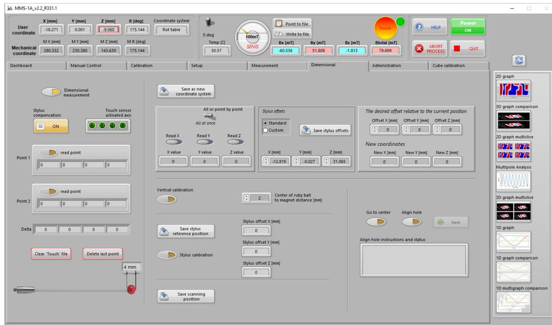
**Dimensional measurement 尺寸测量：** 在使用此功能时建议换上红色球的尺寸测量探头，使用键盘移动探头进行测量。
