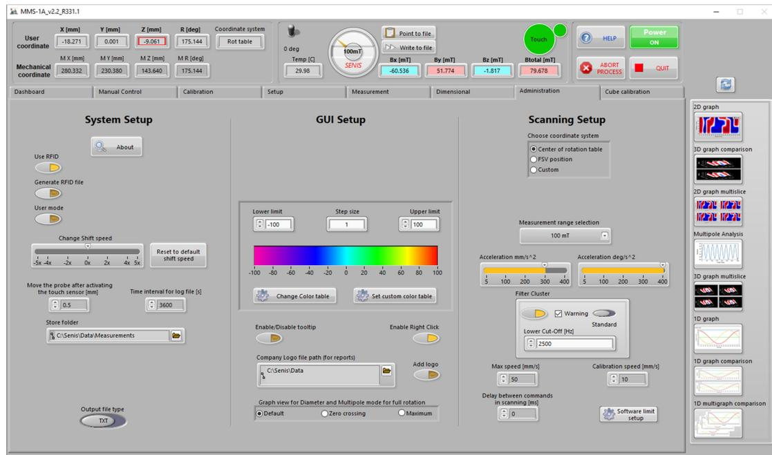
**System Setup 系统设置:** 使用 RFID 探头识别，可以减少探头与其配置文件不匹配的可能。
