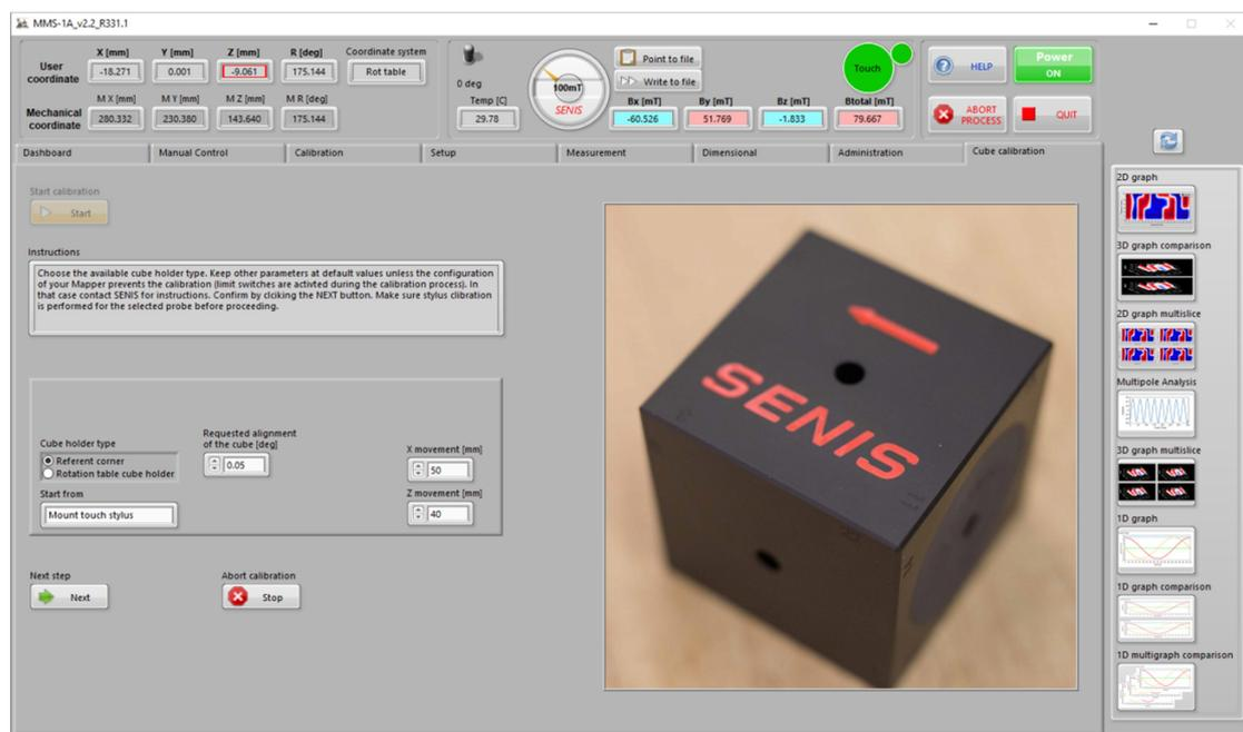
**Cube Calibration 探头方铁校准:** 方铁对探头的 BxByBz 正交性进行测量，每个方向的角度将
