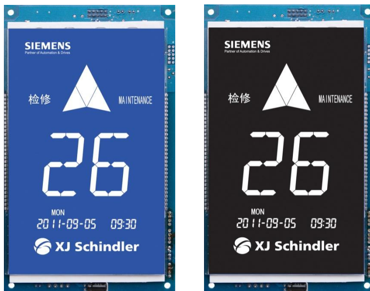
图 3-3-6-2 轿厢显示电脑板类标配 SCH5600-02J
