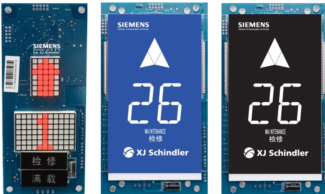
图 3-3-6-2 轿厢显示电脑板类标配 SCH5600-02J
