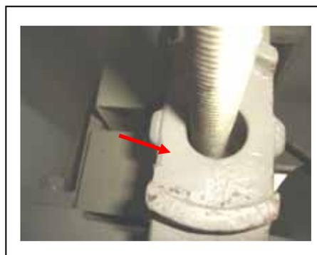
弹簧轴和铁心的卡死情况的发生会致使制动器失效导致重大事故的发生、要非常注意。
