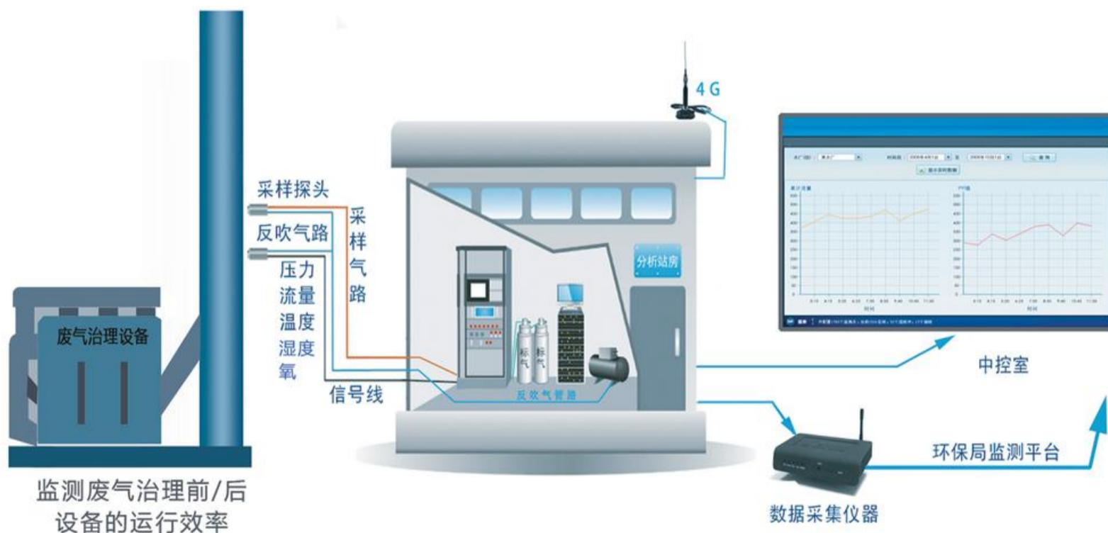
■ 固定源废气排放口在线监测系统安装示意图
