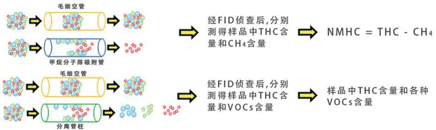
仪器采用专用色谱柱组合、中心切割加反吹技术和氢火焰离子化检测器（FID）技术相结合对VOCs组分进行分析。
