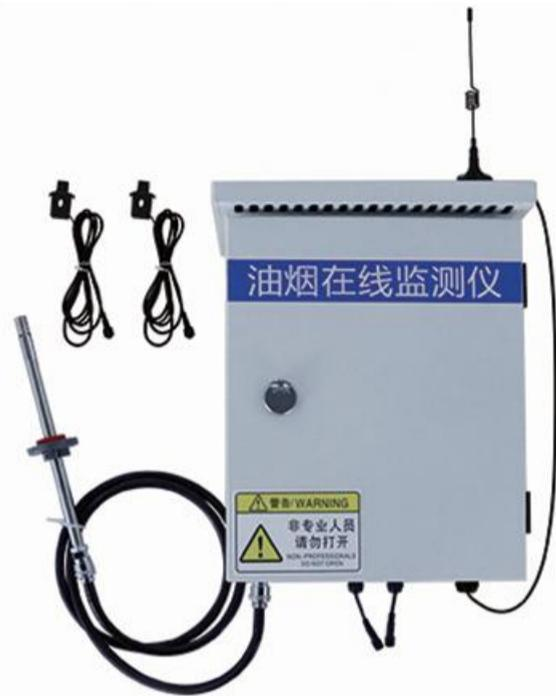
该系统可以实时监测餐饮企业油烟排放浓度、非甲烷总烃、颗粒物,净化器的运行状态和风机运行状态;可以查询、统计和分析不同阶段的油烟监测情况;并具备超标自动报警提示的功能;系统采用国家标准的HJ/T212传输协议,可以支持多种环保局平台,并且可以结合地理信息系统(GIS)实现不同时空、不同维度图文一体化应用管理。
