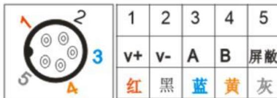
②根据采集器及电源（DTU 等设备）位置，从首端或尾端的设备连接至采集器与供电电源（如系统中的通讯线大于 100 米时，需考虑在后端加载 120Ω 匹配电阻）。设置好平台与采集器的采集上传频率（刚安装好的设备采集频率可设置 2 分钟一次，等数据正常后再按设计要求设定）。
