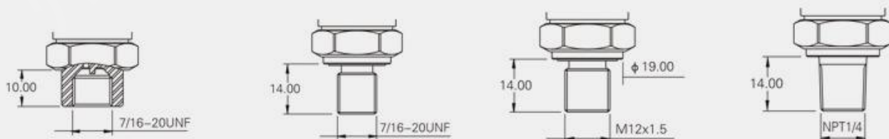
7/16-20UNF内螺纹可选带顶针
