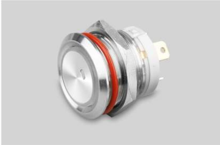
LB19E-P10 ■/E+XD▲▼/○ 平头环形+小点发光 / 1NO触点 可配专用接插件 5-24V/220V,其它电压定制 重量:
