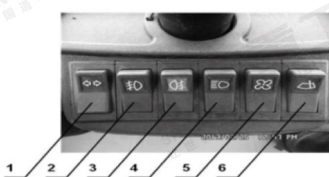
1. 转向指示灯 2. 后大灯开关 3. 前照灯开关 4. 远光灯 5. 风扇 6. 雨刮器
