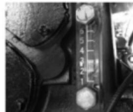
发动机怠速运转五分钟后，打开检油螺检查油位。
