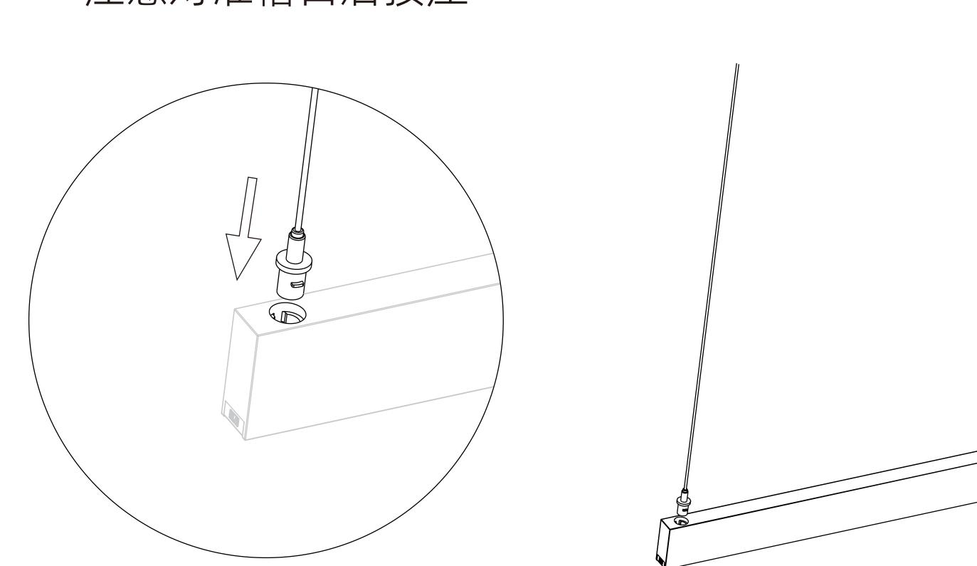
2. 保持按压吊线端头,并将端头顺时针旋转90°
