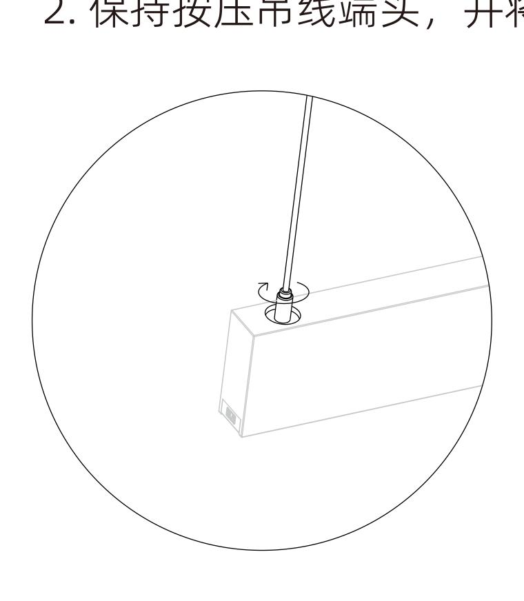
3. 松开端头后,若端头正常回弹至与灯头平行,则此端头安装完成,继续安装另外一处端头
