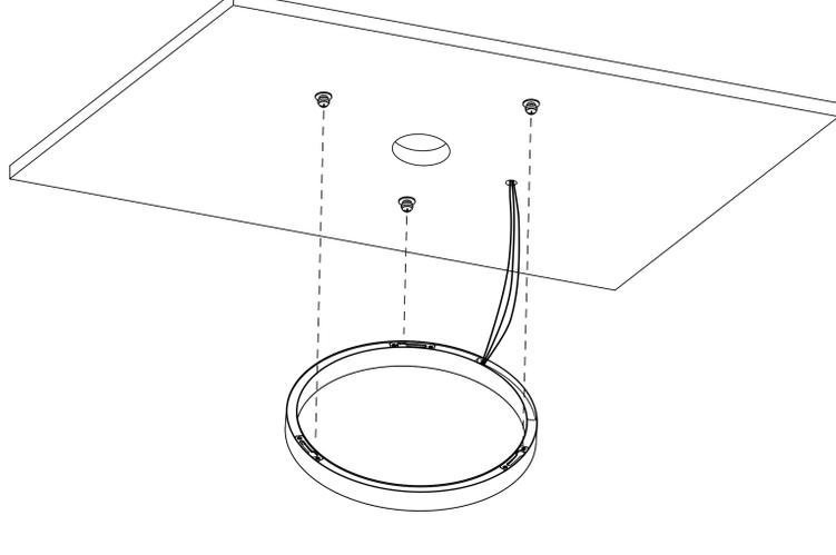
4. 顺时针旋转灯头直至不能转动，确保所有吸顶灯固定件均已卡入
