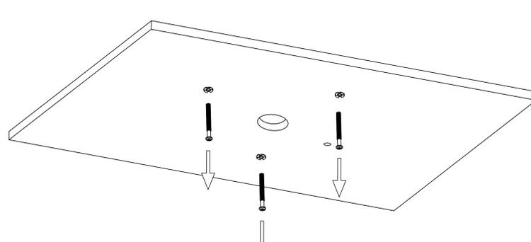
7. 将螺丝套入吸顶灯固定件，重新拧入膨胀钉
