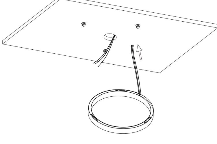
2. 灯头与电源接线，接线前请先断电再操作
