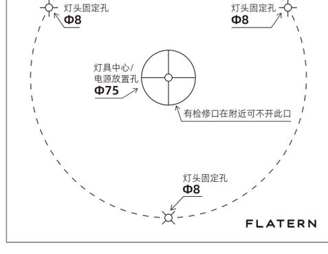
2. 移开定位图纸，用定位图纸规定孔径的开孔器开孔
