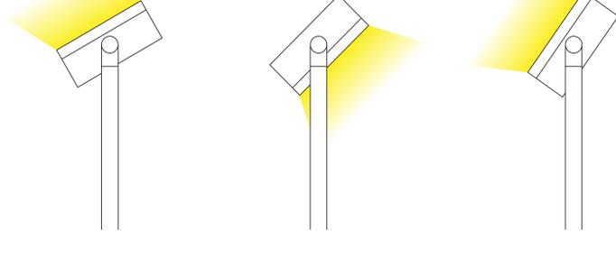
灯头横向可旋转范围为360°，横向旋转时，灯头与灯杆一同绕灯杆底部旋转
