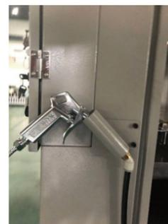
可对工件进行机内除屑冲洗
