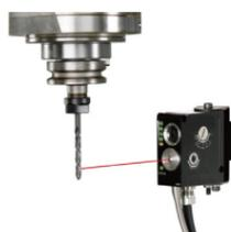
激光（非接触式）刀具折损检测
