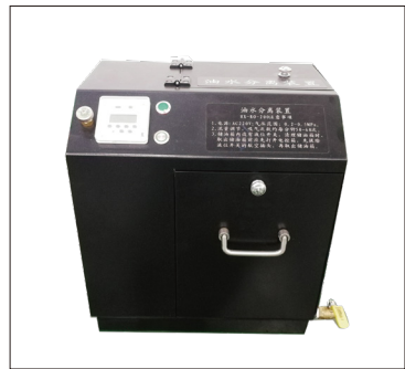
油水分离器 实现油水分离、提高切削液使用寿命, 改善加工车间环境。
