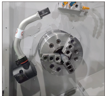
对刀仪 自动进行刀具补正。
