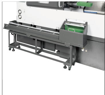
工件传送装置 成品接料器接收到完成品后, 通过传送装置, 搬运到指定位置。(此选配没有包含工件接收盒。)
