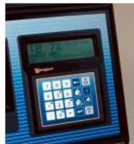
菜单操作简单直观，开机后 1.将要测的谷物倒入漏斗； 2.按“进料”键，自动进样； 3.测试，10 秒钟内通过键盘选择谷物品种； 显示结果并打印出来。
