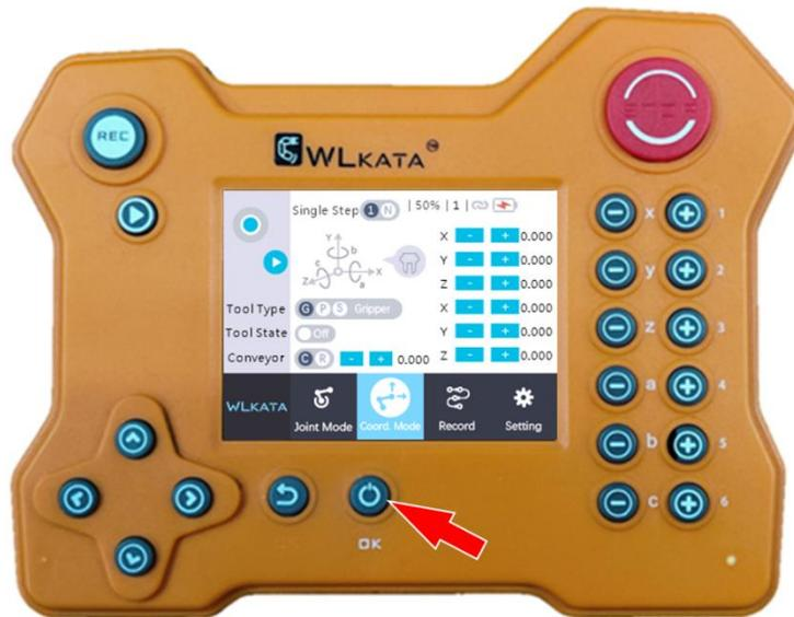
若未成功连接 (连接后机械臂重启也会造成连接断开); 点击进入示教器设置界面, 点击“搜索”, 即可重新建立蓝牙连接;
