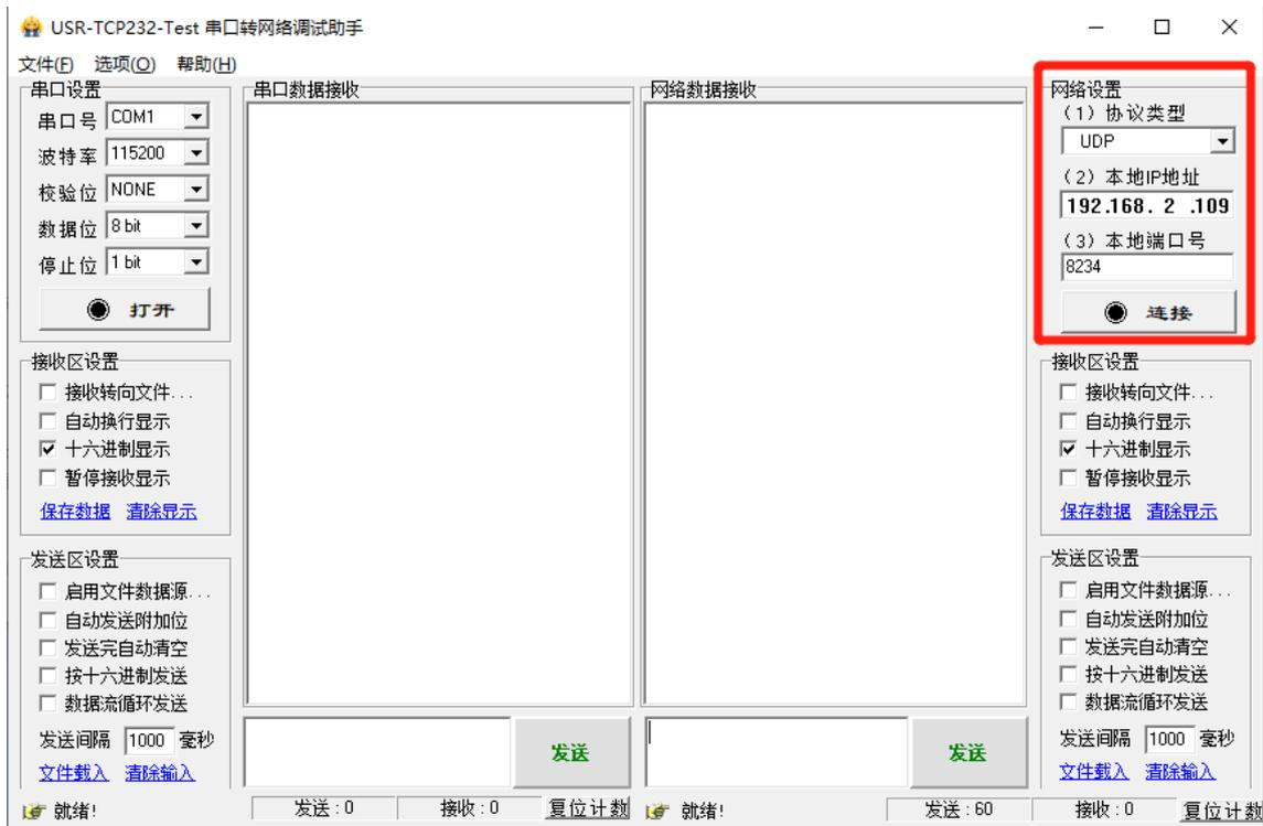
(2) 按控制器返回的连接信息，填写目标主机 IP 与端口号，发送 “\$h” 测试；
