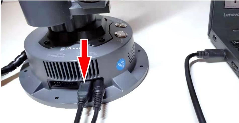
第 2 步：打开 WlkataStudio，检查机械臂固件版本：选择正确串口，按下机械臂底座的“REST”按钮，观察机械臂返回的开机信息，红框位置分别显示机械臂及控制器固件版本（旧版本固件不显示版本信息）；
