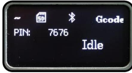
②长按示教器电源键 3s 打开示教器，屏幕右上角无线连接图标闪烁
