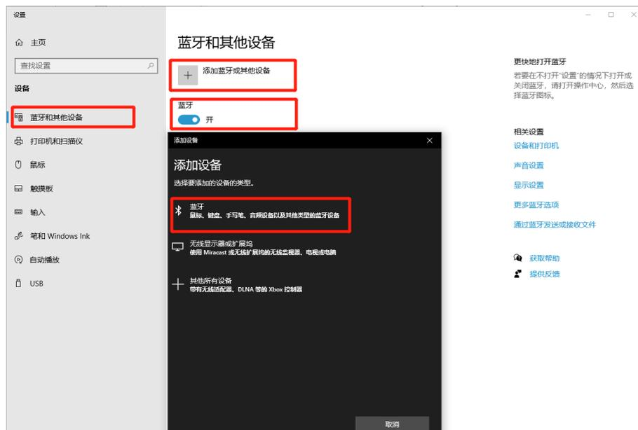
②选择查找到的控制器名称蓝牙设备（默认：mirobot），并输入 PIN（默认：7676）进行连接；
