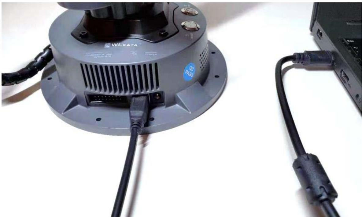
图 2.2 连接 Mirobot 机械臂与计算机
