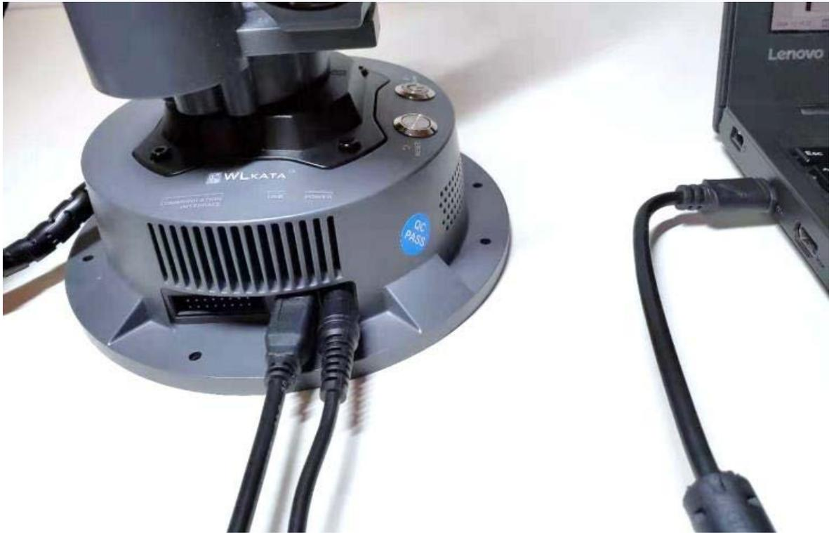
图 2.3 连接机械臂与电源
