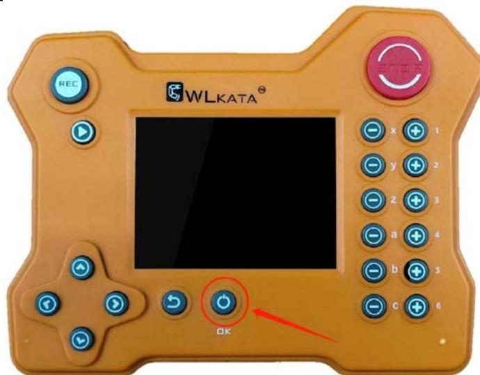
图 2.48 蓝牙示教器开关机按钮
