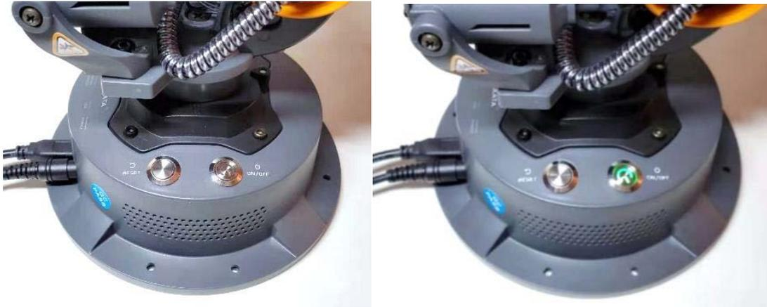
图 2.12 打开 Mirobot 机械臂的开关
