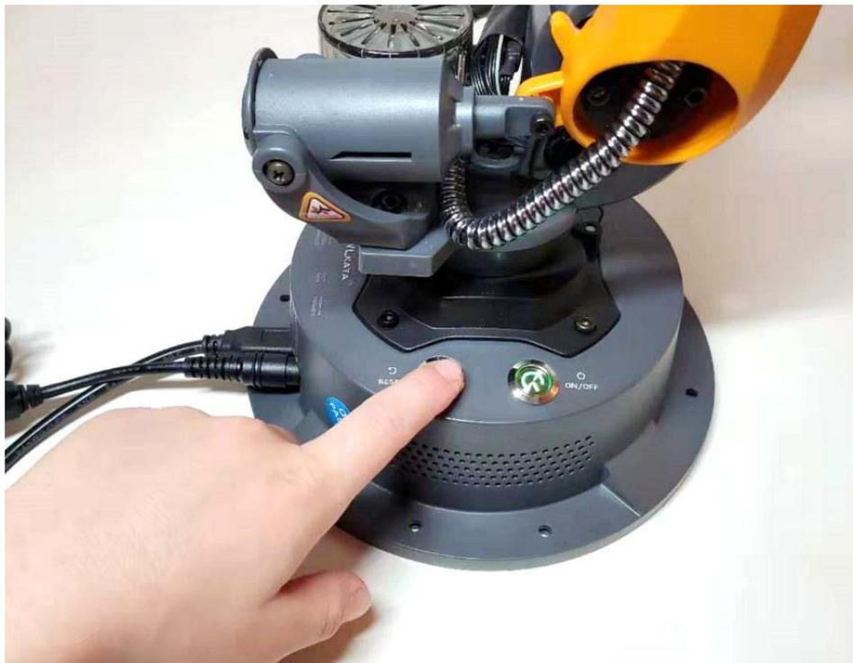
图 2.18 机械臂的底座上的复位按钮
