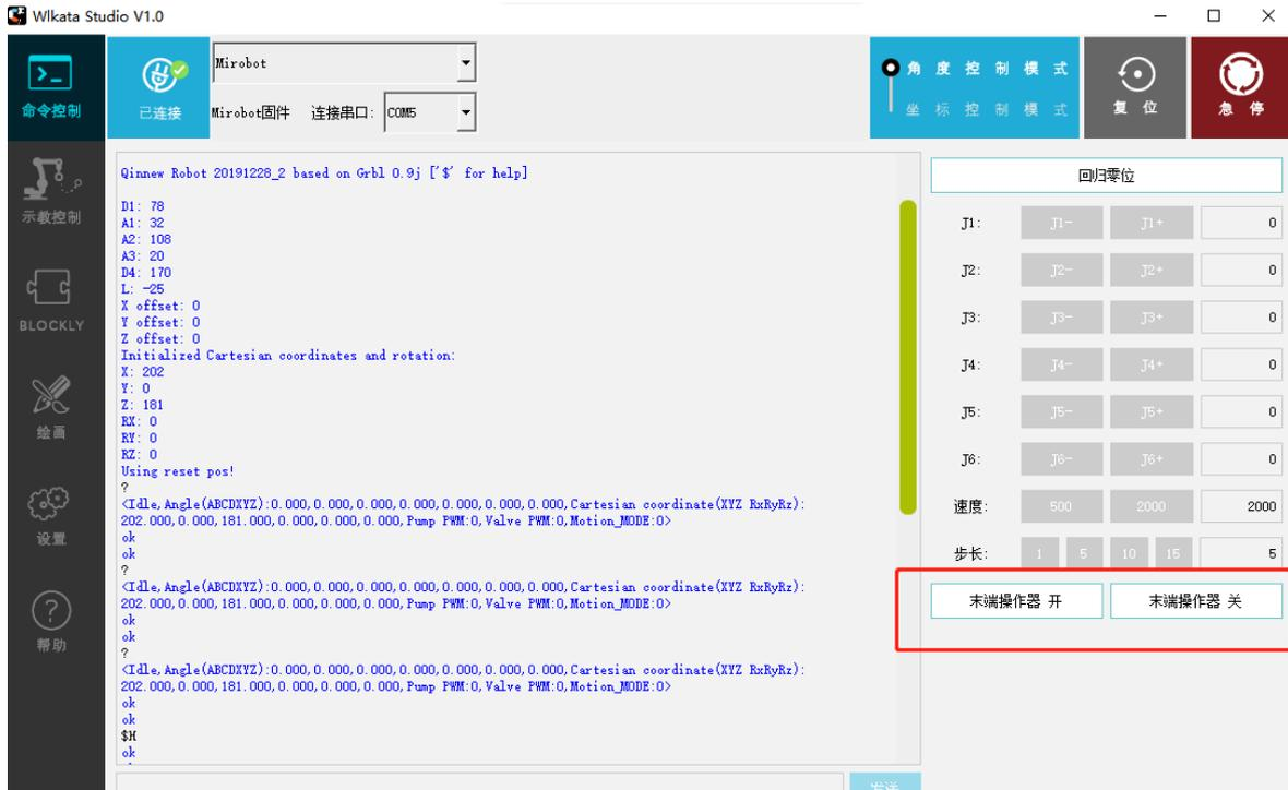
图 2.33 打开/关闭夹具命令
