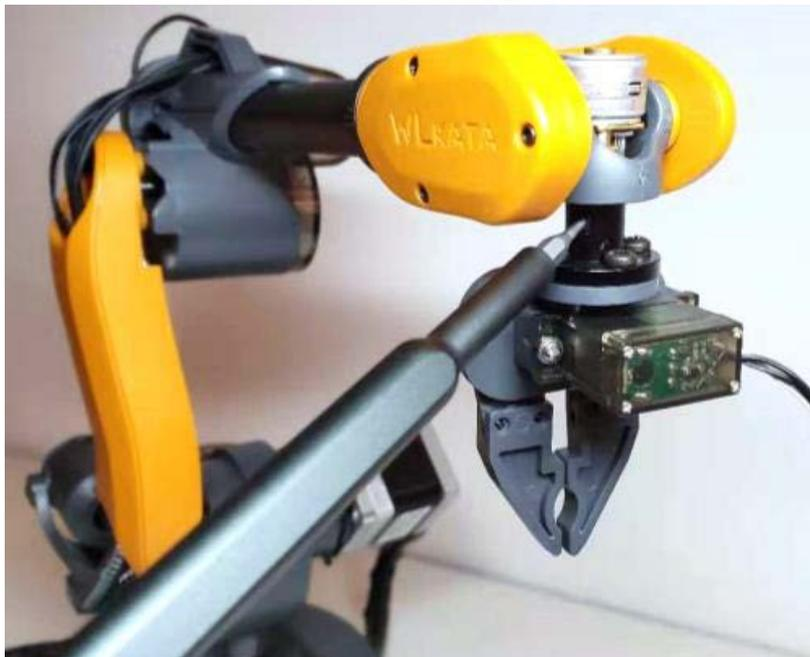
图 2.30 夹具的安装
