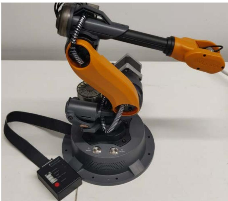
图 2.49 蓝牙扩展模块和 Mirobot 机械臂的连接
