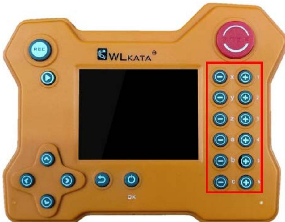
图 2.55 控制6轴方向的6组按键
